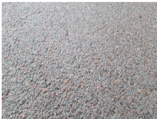
Поверхность изделия до снятия цементного молочка
