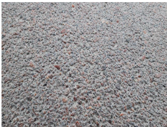
Поверхность изделия после снятия цементного молочка
